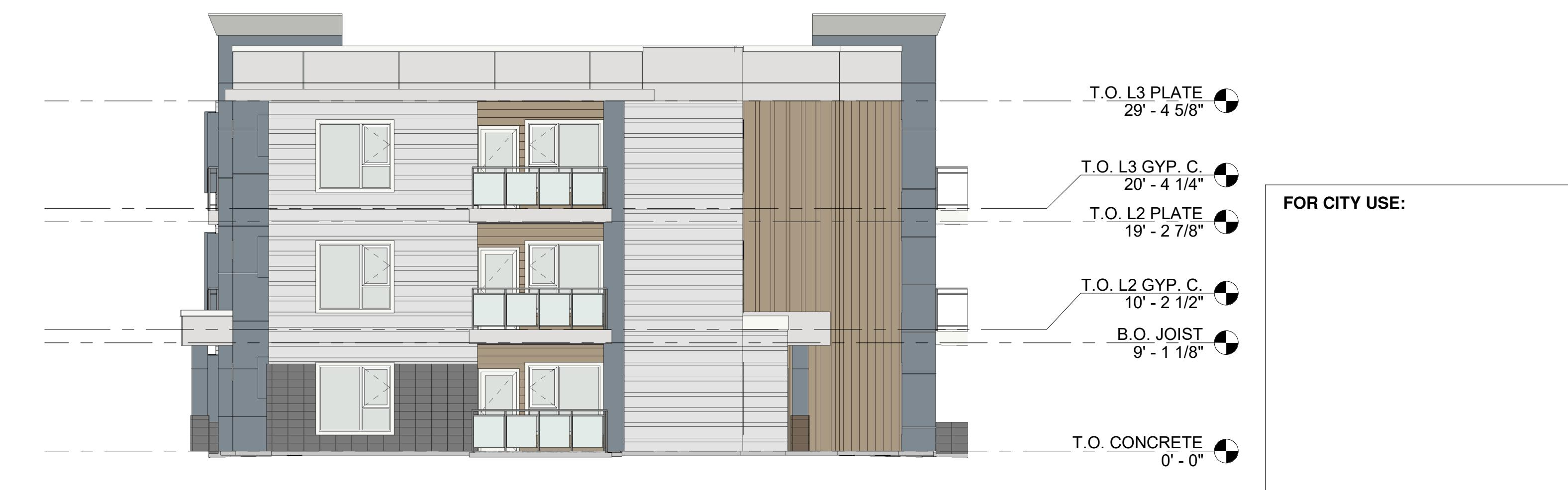
④ COLORED RIGHT ELEVATION - BUILDING TYPE A - SCHEME 1
