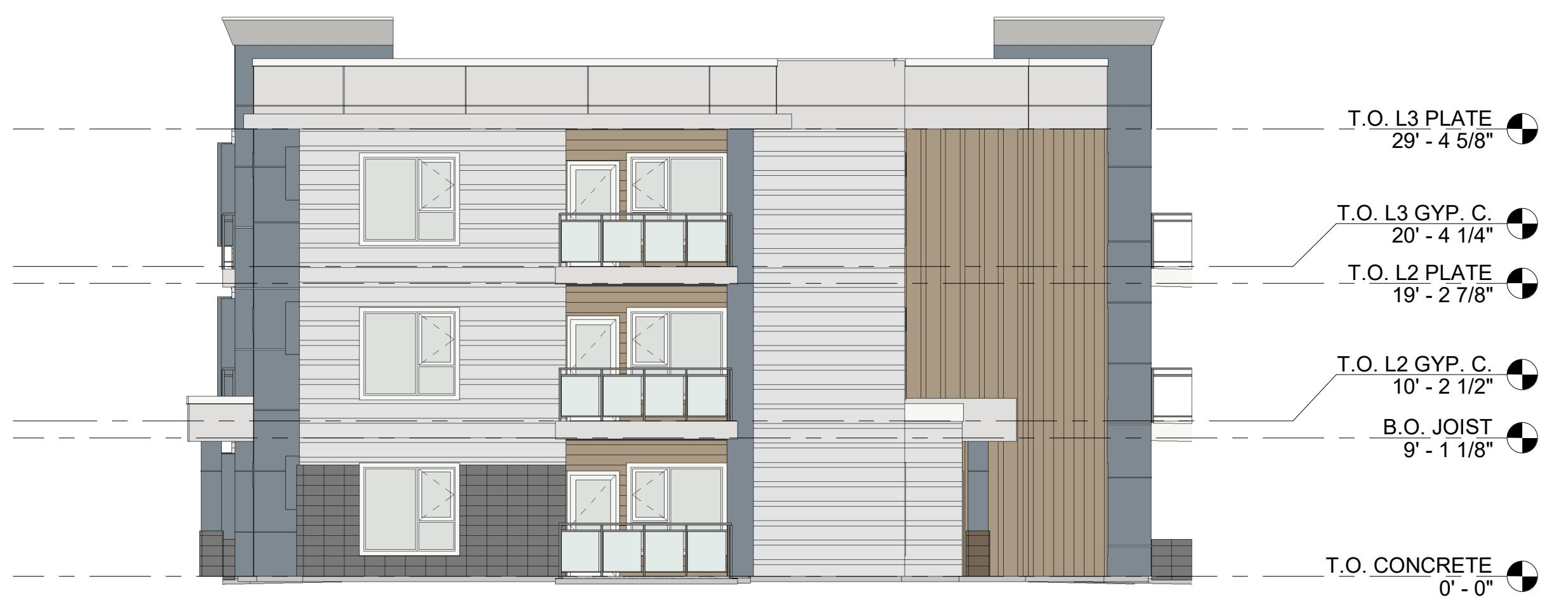
④ COLORED RIGHT ELEVATION - BUILDING TYPE A - SCHEME 1
