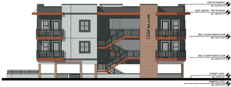
1 SOUTH ELEVATION scale: 1/8" = 1'-0"
